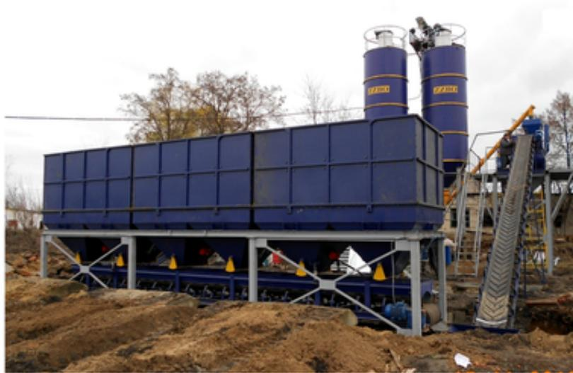
Бетонный завод РБУ-2Г-АЛ с ленточной подачей
