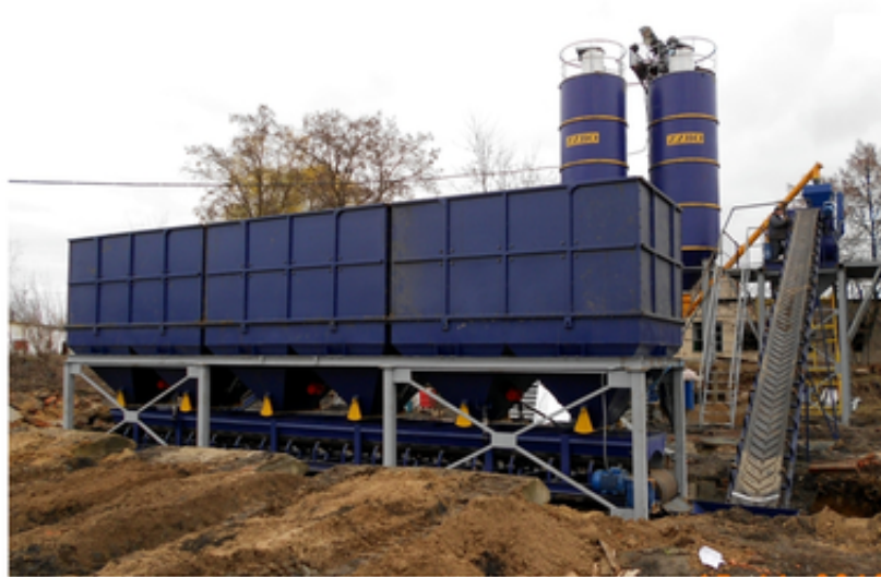
Бетонный завод РБУ-2Г-АЛ с ленточной подачей
